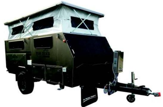
Tare weight 1350 kg / ATM 2000kg / Ball weight 130kg
